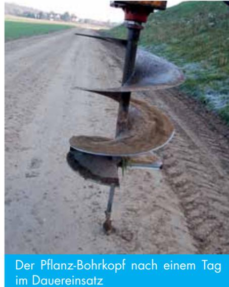
Der Pflanz-Bohrkopf nach einem Tag im Dauereinsatz
